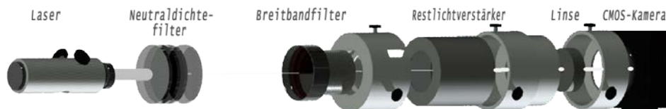
Abb. 1 Explosionszeichnung der photonenzählenden Kamera
