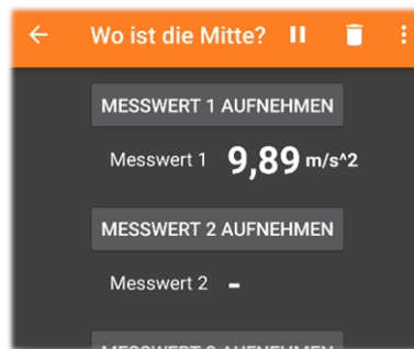
Abb.1: Ansicht der Messwertaufnahme in phyphox zum Modul „Wo ist die Mitte?“
