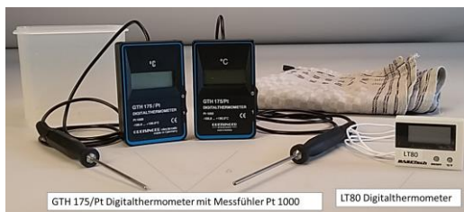
Abb.2: Experimentiermaterial für ein Modul, in dem Schülerinnen und Schüler Messunsicherheiten von Messgeräten bewusst wahrnehmen sollen, mit zwei Digitalthermometern GTH 175/Pt mit Messfühler Pt1000 und einem Digitalthermometer LT80, einem Behälter für Wasser und einem Handtuch.
