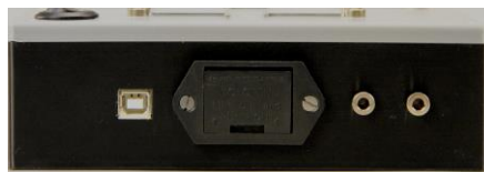
Abb. 2: Seitenansicht des interaktiven Steckbrettes mit USB-Anschluss, Batteriefach und einem Steckplatz, der für die Auswahl der auf dem Steckbrett aufzubauenden Schaltung genutzt wird. Hierzu wird der Steckplatz mit einem Widerstand besetzt, der Arduino misst die abfallende Spannung und wählt je nach Spannung eine unterschiedliche Lösungsmenge aus.
