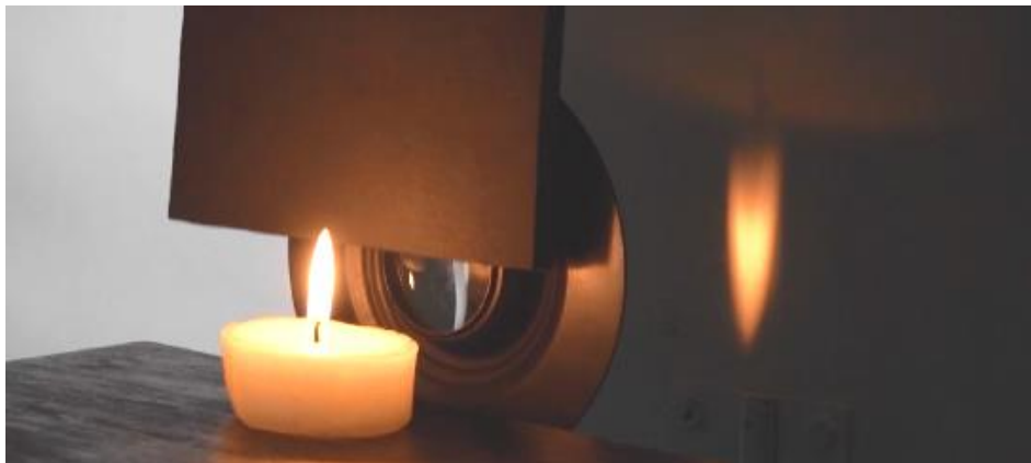
Abbildung 1: Darstellung der halb abgedeckten Linse und des sichtbaren Bildes am Schirm.
