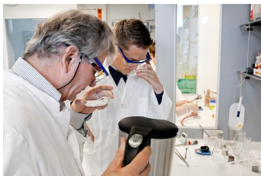
Abb. 2: Geruchsprüfung bei der Komplexbildung von Pfefferminzöl in Cyclodextrinen
