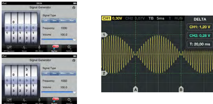
Abb. 1: Links: Überlagerung von zwei Tönen mit annähernd gleichen Frequenzen. Erzeugung der Töne durch eine Tongenerator-App. Rechts: Oszillogramm der entstehenden Schwebung. Die Schwebefrequenz ergibt sich als Differenz der Ausgangsfrequenzen und kann im Experiment bestätigt werden.
