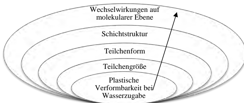
Abb. 1: Zunehmend komplexere Ebenen einer Struktur-Eigenschafts-Betrachtung zur plastischen Verformbarkeit feuchten Lehms
