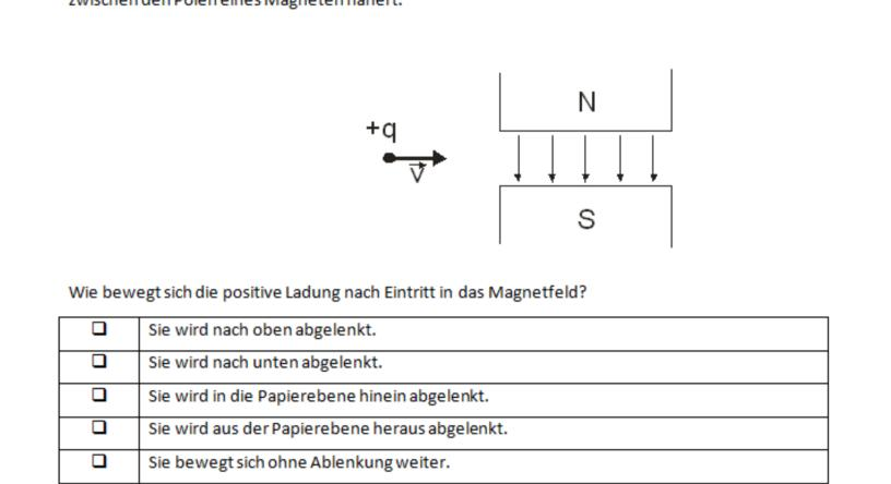
Die Abbildung zeigt eine positive Ladung q, die sich mit konstanter Geschwindigkeit veinem homogenen Magnetfel
