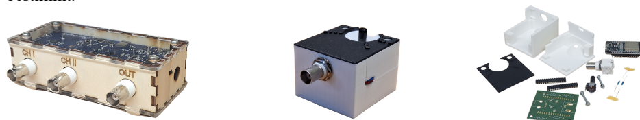
Abb. 2: Verwendete Sensorboxen. Links: phyphox-E-Box. Mitte: phyphox-h-Box. Rechts: phyphox-h-box als Bausatz.
